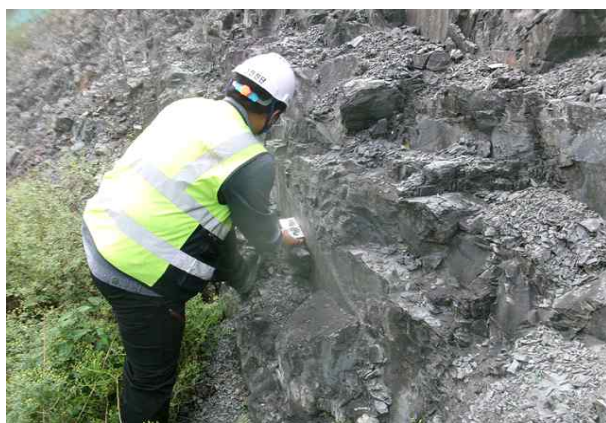
절리면 경사/경사방향 측정
